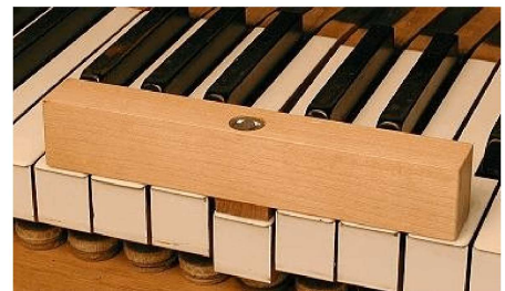
Figure 2 : le testeur de rapport mécanique enfonce automatiquement une touche-test de 6 mm.
